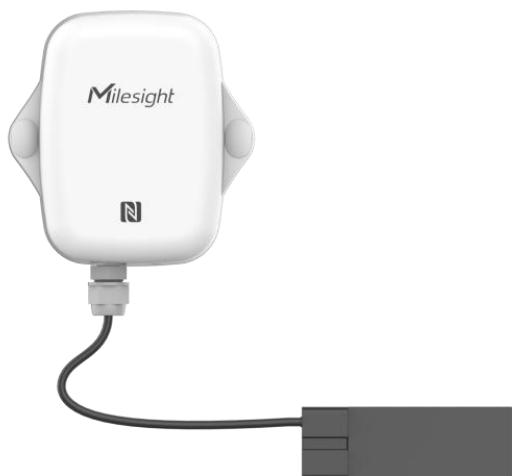
FINDER EM300-CL 是一款专为洗手液液位状态检测而设计的电容式液位传感器。产品利用液体与电极之间的电容变化来判断液体存在与否。采用非接触式检测，将电极片探头水平安装于被测容器外壁下方，即可轻松检测容器是否缺液并及时发送无线信号告警。
