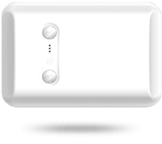
FINDER VS350 是一款专为过道人流分析而设计的人数统计传感器，采用双 PIR 探头，能够实现双向人流统计。同时产品内置温度传感器，有效感知周边环境的温度变化。此外，产品内置 2 节 2700 毫安时锂亚电池，可连续使用 4 年无需更换。
